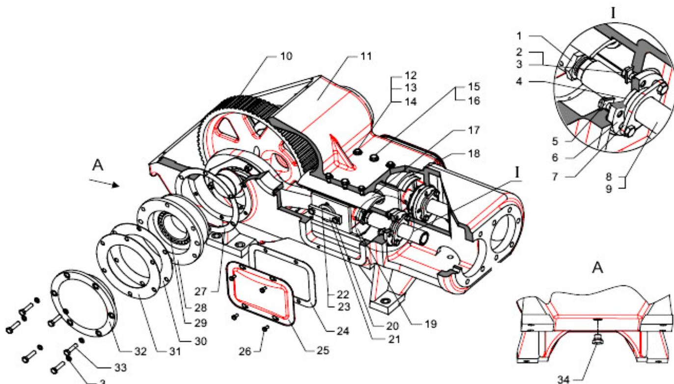
Рис.11. Блок привода НБ32.01.000.
